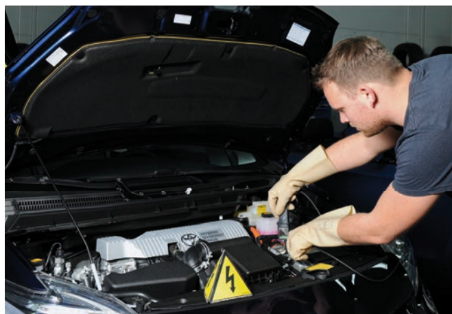
Mesure de l'absence de tension
