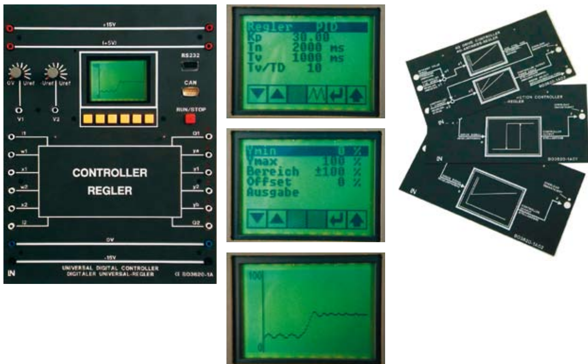
Régulateur numérique universel avec masques
