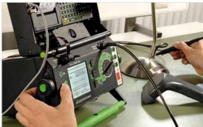
**Contrôle de tension, phase, continuité et polarité ainsi qu'indication du sens du champ tournant.**
